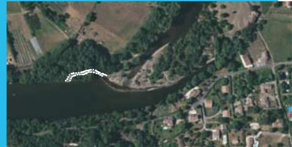
Réalisée sur la berge en rive gauche, cette rivière artificielle de 120 m de long permettra aux poissons, en particulier l'Apron du Rhône, de contourner le seuil et de remonter le Chassezac.
