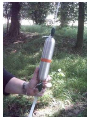
4. Ouvrir la vanne basse, puis la vanne haute de l'ampoule. Dès que l'eau sort, placer une réduction en sortie (tube 18<sup>e</sup> de pouce en acier pour les petites ampoules, réducteur de flux pour les grandes) :
